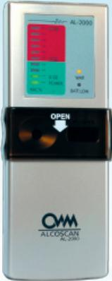
Это персональный определитель алкоголя в организме человека на основании анализа выдыхаемого воздуха. После сигнала о готовности прибора, испытуемый дует в воронку в течение 2–3 секунд. По завершении продувания на шкале загорается ряд огньков, наивысший из которых указывает концентрацию алкоголя в крови.
